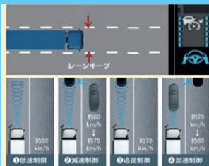
走行車線及び先行車を認識し、車線維持に必要な運転者の操舵力を軽減します。
