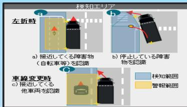
左折時や車線変更時に側方の衝突事故等を防止するため障害物の検知し、衝突の可能性が高いと判断した場合には、運転者に衝突を回避するよう警報します。
