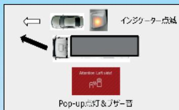
後側方から自動車等が接近している場合に、運転者に対して注意喚起を行うことで、左右への車線変更時の安全性を高めます。
