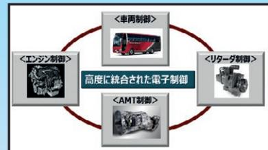
峠などの下り坂でのスピード超過による事故を防止するため、制動力を統合的に制御することにより自動的に予め設定した速度に制限します。
