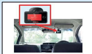
大きな事故が発生した際、その衝撃を検知して自動的にコールセンターへ通報します。
