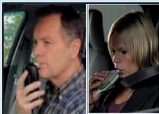
ドライバーの呼気から設定値以上の濃度のアルコールを検知した場合、エンジンが始動しないようにします。
